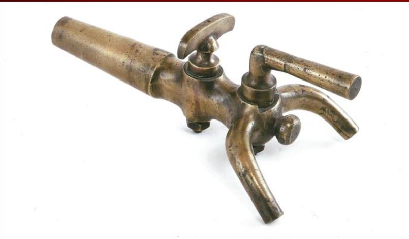
*Tireuse à deux becs que l'on place dans le trou de bonde d'un fût de 225 litres, pour remplir 300 bouteilles de 75 cl.*
